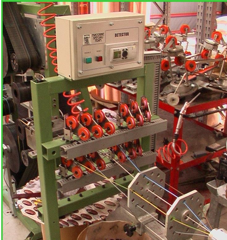
El dispositivo monitoriza la presencia del hilo o cable en condiciones de trabajo. El final de la bobina, la quebrada de cable / hilos y la ubicación incorrecta del producto dará una señal de alarma que será gestionado por PLC dedicado.
